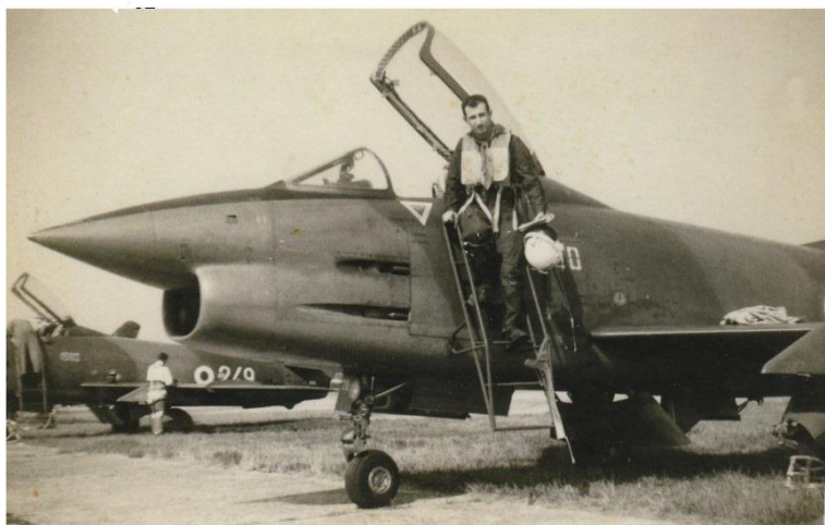
G91 con la punta avanti poi sostituita con una fotocamera Vinten. Oltre a questa il veivolo ne aveva già una ventrale una a destra e una a sinistra con collimatori all'interno di cock-pit.
